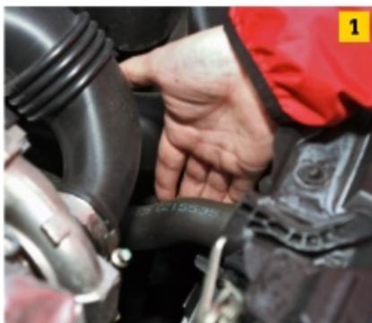
Moteur froid, démarrez et posez la main sur la grosse durite allant de la culasse au radiateur de refroidissement **1**. Elle doit se réchauffer d'un coup après 5 à 8 minutes. Si la température augmente plus tôt et progressivement, il est à remplacer (200 €).
