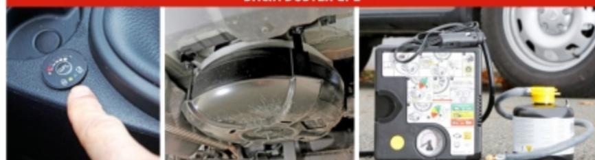
Le petit interrupteur permet la bascule entre les modes (GPL/essence) et fait office de jauge (GPL). Le réservoir de gaz (34 l) occupe la place de la roue de secours. Celle-ci, indisponible, est remplacée par un kit anticrevaison.
