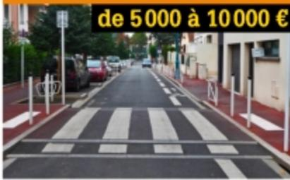
Le dos-d'âne se fait de plus en plus rare car le ralentisseur en trapèze (dit coussin berlinois) a l'avantage d'être moins cher et plus rapide à installer. En outre, il secoue moins les usagers des autobus.
